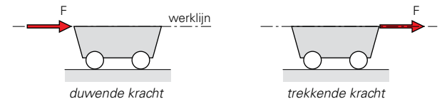
2.3 Een kracht mag over zijn werklijn worden verplaatst.
